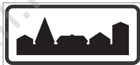
ابتدای منطقه مسکونی
